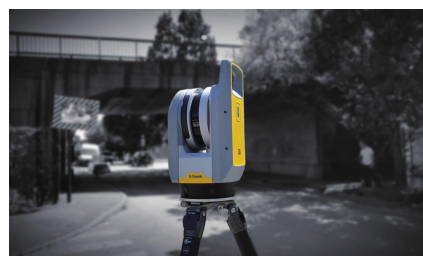
Trimble X7 3D 스캐너의 현장 기록
